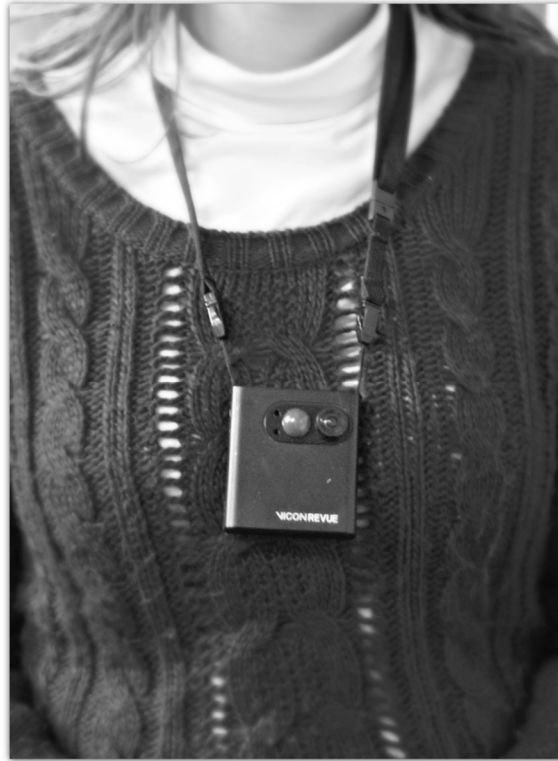
Figura 1. Dispositivo Vicon Revue® (versão comercial da câmara SenseCam)
