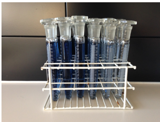
Figura 41: Tubos contendo soluções padrão para a determinação da curva padrão do ácido gálico.
