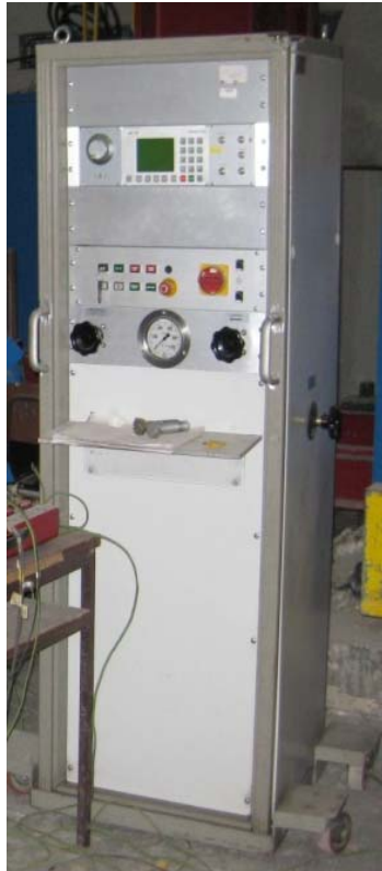
Figura 4.7 – central de controle para aplicação de força.
