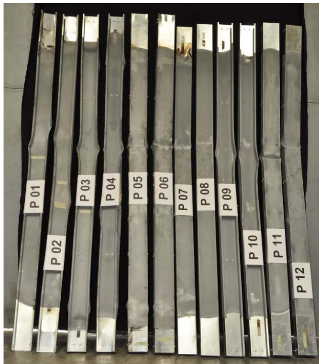
Figura 4.57 – Configuração deformada ao término dos ensaios: elementos ensaiados
