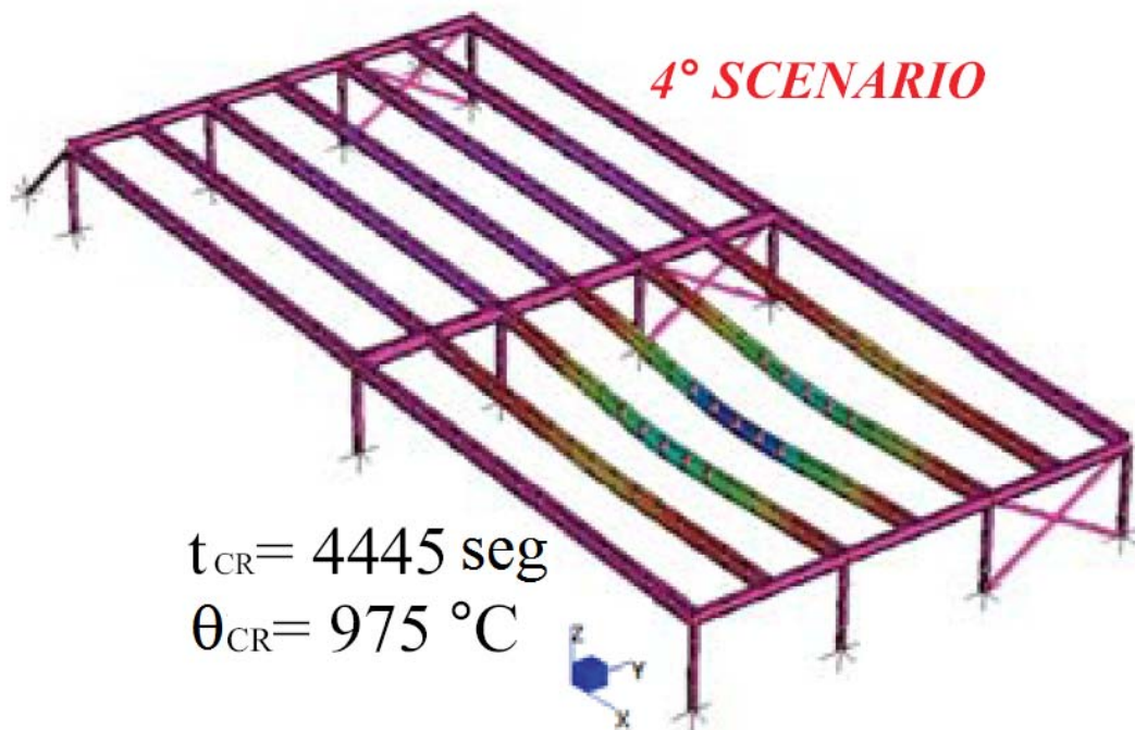
Figura 2.8 – Modelos avançados para a análise mecânica: estrutura global modelada em elementos de barra. Adaptada de: CROSTI (2009)
