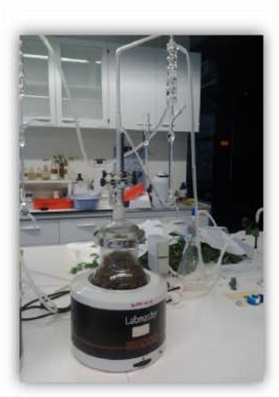
Figura 1: Hidrodestilação com aparelho tipo Clevenger.
