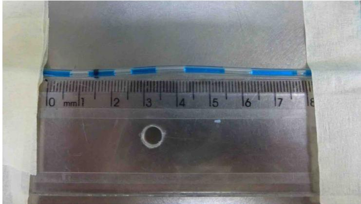
Figura 5.2: Mangueira de saída acoplada a régua para medição de bolhas
