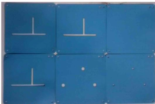
Figura 2.18: Fitas de LTCC processadas neste trabalho para produção de um gerador de bolhas
