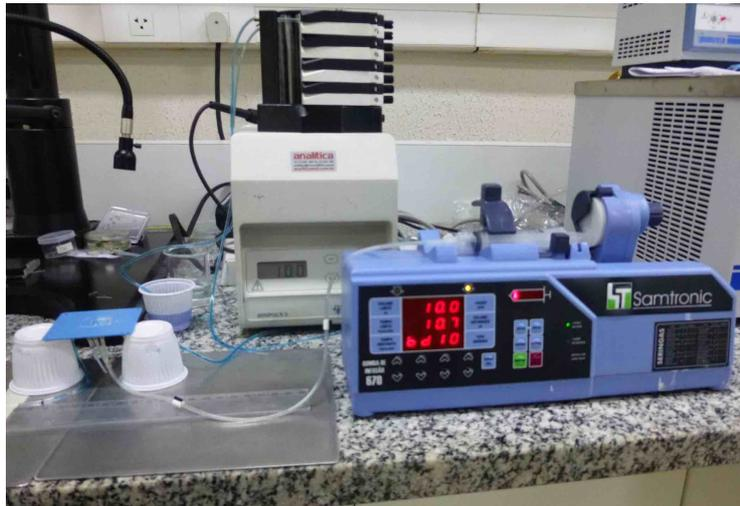
Figura 5.1: Bomba peristáltica e bomba de infusão conectadas ao gerador de bolhas
