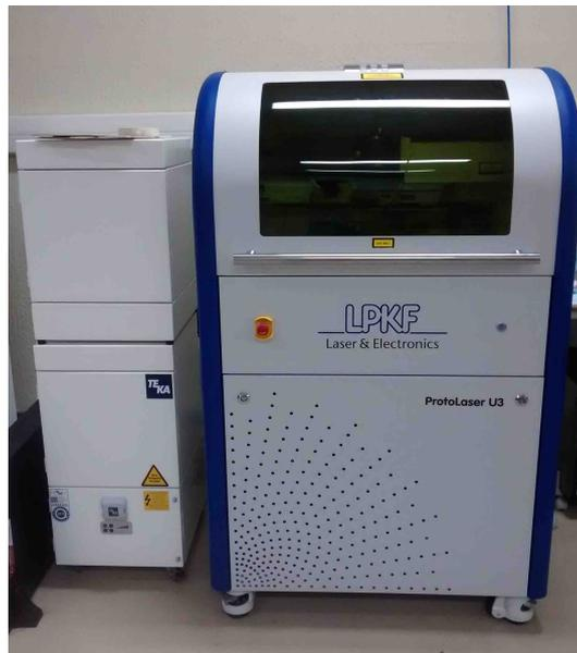
Figura 2.17: Foto do equipamento de corte a laser, ProtoLaser 200 da LPKF utilizada neste trabalho para processamento de folhas de LTCC.
