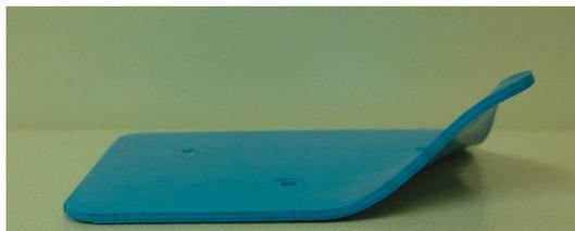
Figura 2.22: Foto de uma estrutura de LTCC mal posicionada sobre a lâmina de alumina durante o processo de sinterização
