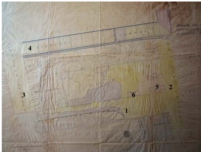
Figura 23: “Indicação dos aterros executados na parte do Pântano de Lourenço Marques /[...] - Escala de 1: 500. - [Moçambique]: [s.n.], 1888, Set. 26. [...]”, AHU (CART m_064_D.1400). Movimento de terras no quarteirão da Cadeia Civil, a primeira área do pântano a ser aterrada: abertura das Avenidas D. Carlos (atual 25 de Setembro) (1); Augusto de Castilho (atual Vladimir Lenine) (2); António Augusto de Aguiar (atual Samora Machel) (3) e de Pedro Álvares Cabral (atual Zedequias Manganhela) (4). Foram construídas contemporaneamente a Cadeia Civil (5) e o edifício provisório da Imprensa do Governo (6), juntamente ao aterro destes tramos das Avenidas Castilho e D. Carlos.
