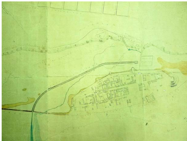
Figura 7: Extrato do “PLANO/ do/ projectado esgoto e aterro/ do/ PANTANO/ DE/ Lourenço Marques/ por/ S. T. HALL/ Dezembro 1876 33 ./ Cópia de/ Augusto de Castilho. Escalla do Plano e secção/ Horizontal 200 pés = 1 poleg. a / vertical 10 pés = 1 poleg. a ” (AHM, cota D1.03/2021).
