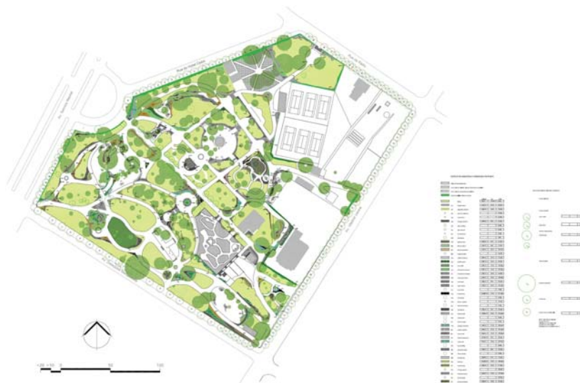
Figura 221: Planta de “Implantação geral - Pavimentos”. Fonte: Projecto de Reabilitação do Jardim Tunduro , 2012. Os percursos assinalados a cinzento escuro, são pavimentos propostos em betão poroso (reconstrução após a demolição do existente — à exceção das novas áreas criadas de raiz junto ao novo bloco de serviços ao longo da Av. Zedequias Manganhela e junto à Casa do Caseiro, assinaladas com um círculo vermelho). Os restantes pavimentos serão reconstruídos em pavé ocre, betonilha, lajetas de betão pré-fabricadas ou pedra da Namaacha. Está prevista a conservação do pavimento da estufa em calçada portuguesa (a amarelo) e a reposição de dois pequenos apontamentos em calçada portuguesa na plataforma central do Jardim (círculos a azul).
