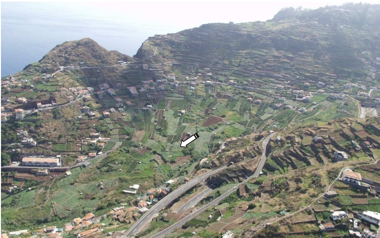
FIGURA V.29 Caldeira (Câmara de Lobos). Vista aérea de uma zona de acumulação coluvionar, com referência do processo de Creep. Fonte: DRAmb
