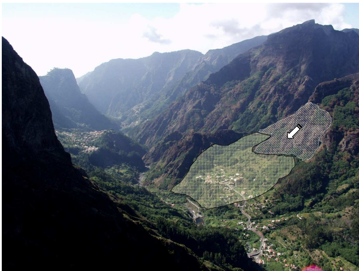
FIGURA V.23 Vista aérea para o deslizamento rotacional da Fajã Escura (Curral das Freiras).
