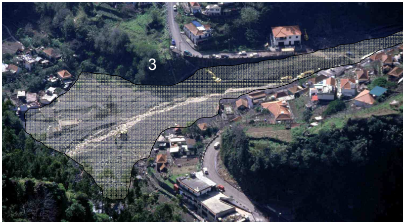
FIGURA V.28 Área afectada pelo fluxo de detritos de 2001. Material depositado em forma de leque (RODRIGUES, 2005).
