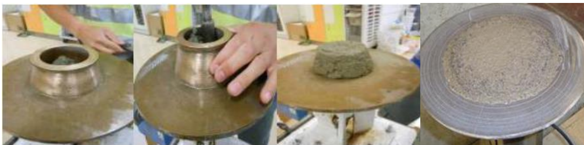
Figura 53 – Procedimento de realização do ensaio de espalhamento
