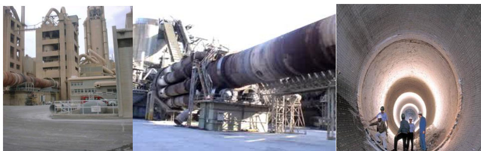
a – Torre de ciclones b – Forno horizontal rotativo c – Interior do forno [14]
