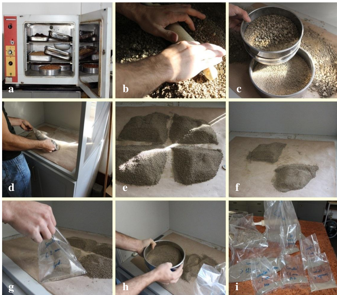
Figura 22 – Tratamento de solo para análise. a) Secagem do solo em estufa a 40°C; b) esbroamento; c) crivagem a 2 mm; d) homogeneização do solo inferior a 2 mm; e, f) quarteamento; g) repetição do quarteamento e separação de solo para a realização de análises; h) crivagem a 125 µm; i) amostras de solo.
