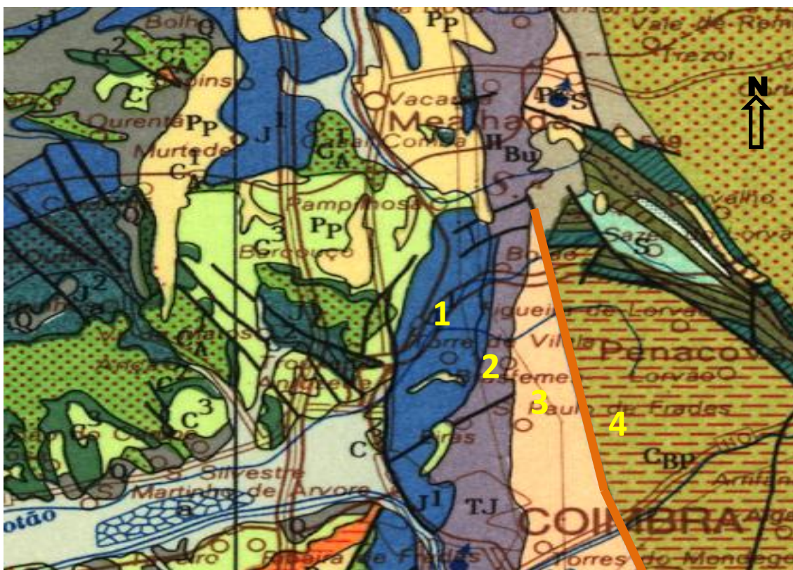
Figura 3 – Excerto da carta geológica de Portugal (1992), na região de Coimbra. 1 - Calcários margosos e margas (Jurássico), onde se localizam duas zonas de estudo; 2 - Grés de Silves: depósitos detríticos (conglomerados, arenitos, e pelitos) com idade do Triásico (Palain, 1976); 3 - Série Negra de filitos (Proterozóico Superior), onde se localizam duas áreas de estudo; 4 – Grupo das Beiras (Proterozóico Superior – Câmbrico); — Falha Porto-Coimbra-Tomar.
