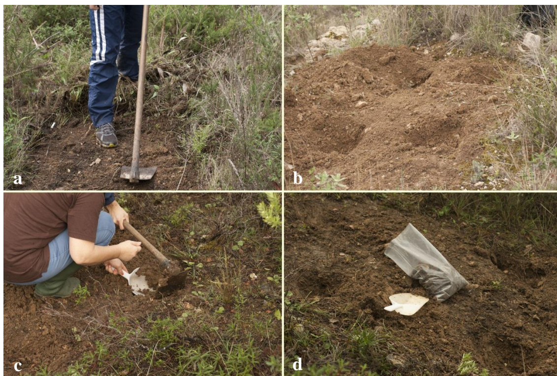
Figura 21 – Método de colheita de solo. a) Limpeza do terreno (4 m 2 ); b) cortes para a colheita de amostras compósitas e observação do perfil; c) recolha transversal de solo; d) amostra compósita.
