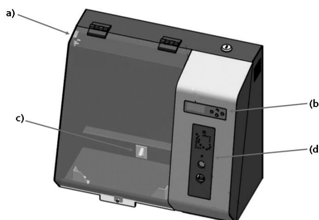
Figura 30 - Desenho técnico da caixa de desfibrilhador "SAFE HEART". a) Sensor de "Porta-aberta"; b) Visor; c) Sensor de "presença de AED"; d) Altifalante e microfone.
