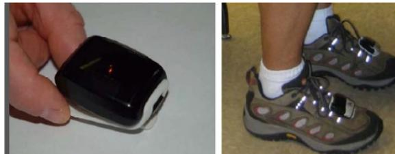
(c) Uso de controlo pela utilização da IMU(*Inertial Measurement Unit*) no pé pelo DEKA arm [74].
