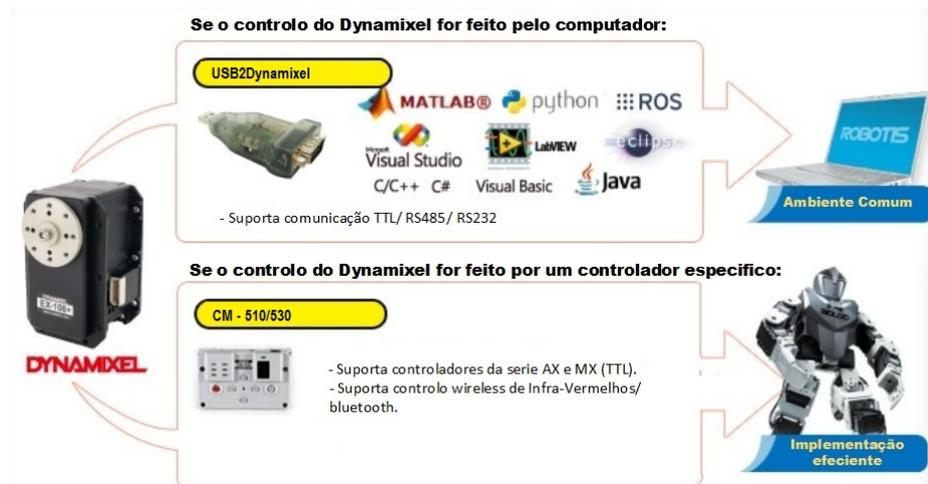
**Figura 3.4:** Opções possíveis para a configuração dos atuadores DYNAMIXEL da ROBOTIS. Adaptado de [77].
