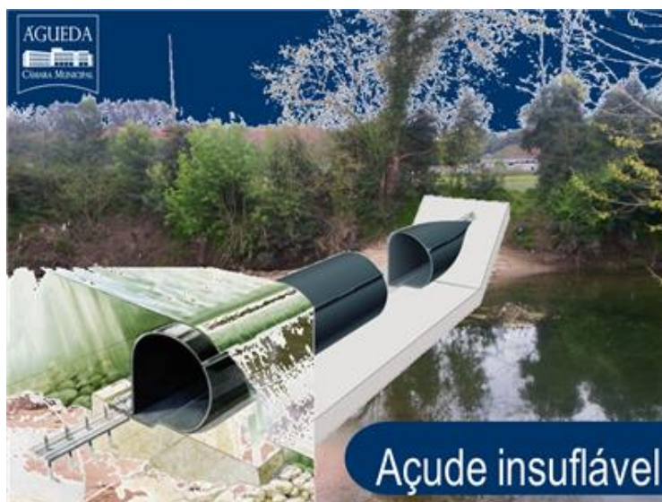
Fig. 37 – Estrutura do açude insuflável do rio Águeda.
