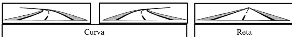
Fig. 32 - Elementos geométricos do traçado de uma estrada, segundo o plano horizontal.
