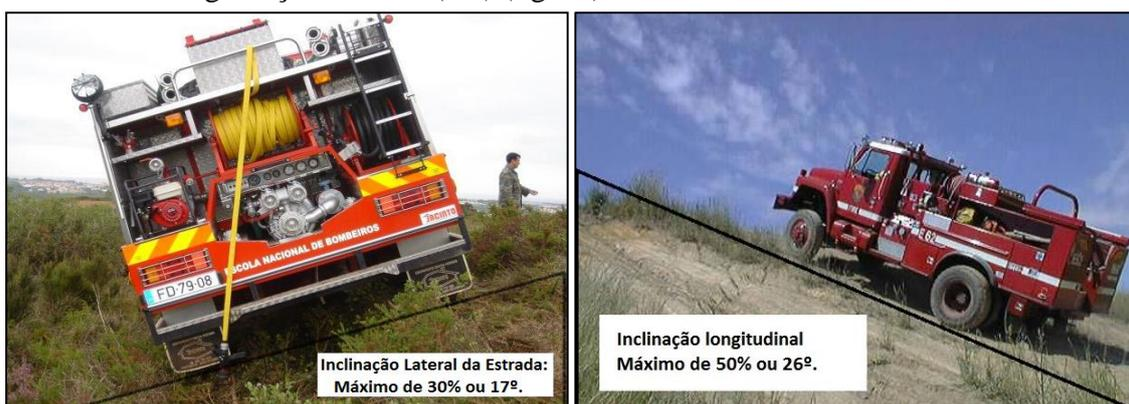
Fig. 30 – Exemplos dos máximos de inclinação que um VFCI consegue transpor em segurança. Fonte: Adaptado de DIRECTION DE LA DÉFENSE ET DE LA SÉCURITÉ VIVILES (1998).
