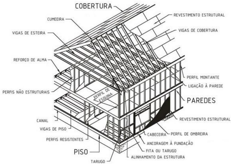
Figura 22 – Esquema de montagem da estrutura em aço – Sistema Light Gauge Steel Framing
