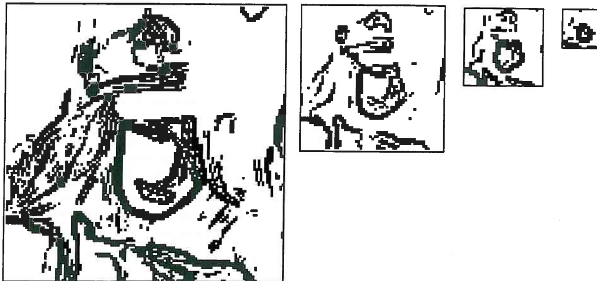
Figura 3.20: Aplicação do detector em cruz de Roberts, seguido do algoritmo de selecção de máximos locais, aos vários níveis de uma pirâmide de imagens reais (a imagem base da pirâmide original pode ser vista na figura 3.3, em cima).
