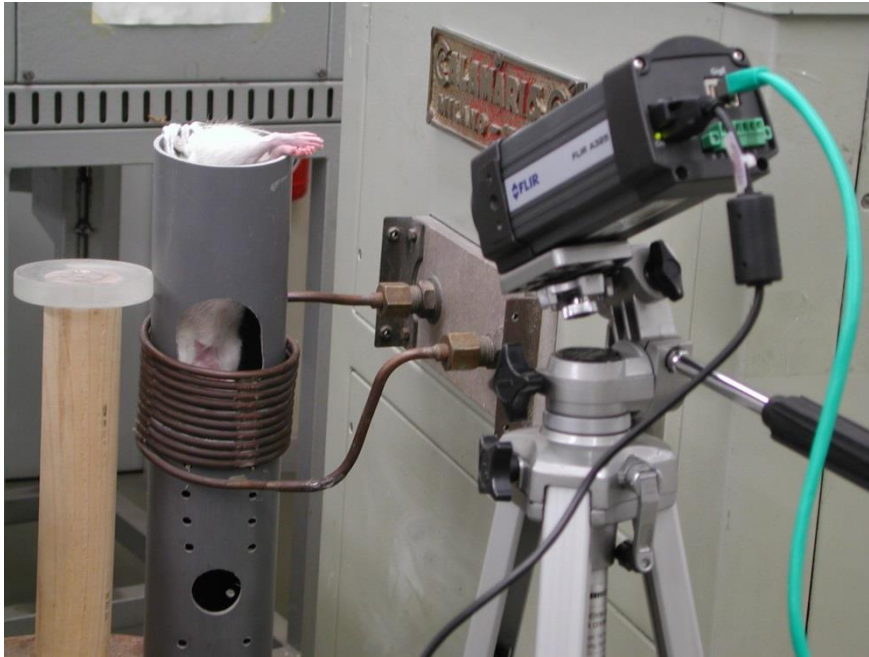
Figura 52 – Tratamento hipertérmico com monitorização por câmara de termografia.
