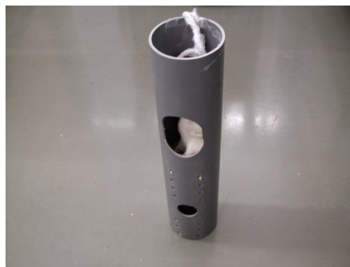
Figura 51 – Adaptador de bobina para hipertermia em rato. O animal é colocado na vertical tendo um apoio regulável para a cabeça na porção inferior do tubo. A região tumoral de interesse fica ao nível da maior abertura.
