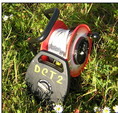
Figura 4.14 - Sonda de nível e fita métrica utilizados nas campanhas piezométricas.
