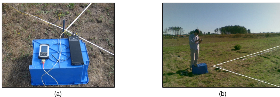
Figura 3.25 - Pormenor do equipamento TEM-FAST 48 (a) e execução da sondagem (b).
