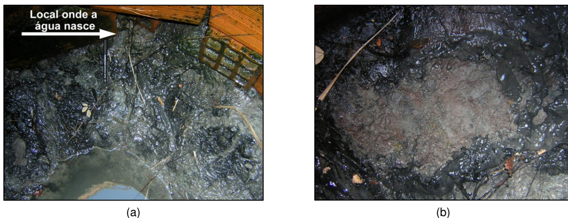
Figura 2.30 - Pormenor do local da nascente da água de Montouro (a) e do estrato argiloso amostrado (b).
