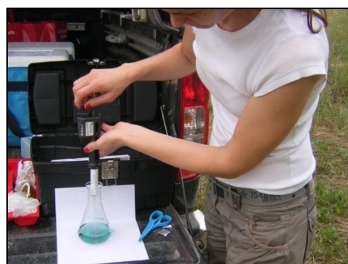
Figura 5.8 - Determinação in situ da alcalinidade.
