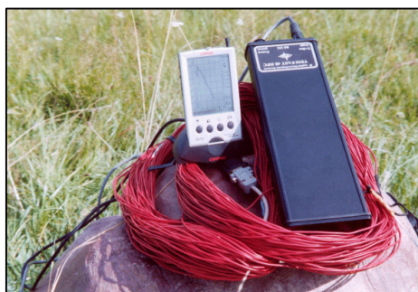
Figura 3.13 - Equipamento TEM-FAST 48 (Applied Electromagnetic Research - AEMR, 2007a).
