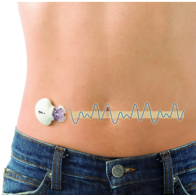
Figura 3.2: O dispositivo invasivo de monitorização da glicose, iPro ®2, em utilização[54].
