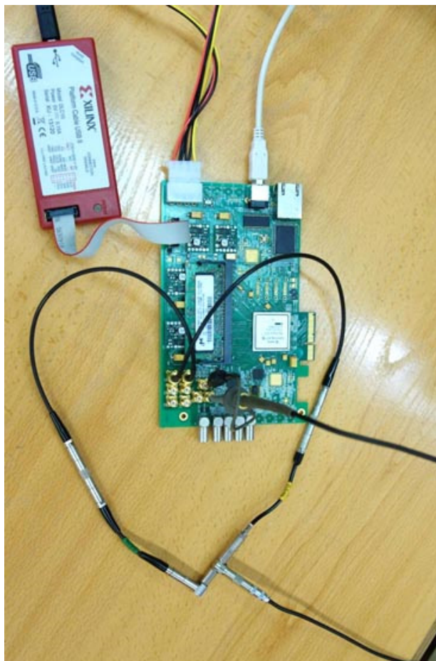
Figura 5.2 – Montagem experimental para teste do Módulo de Detecção de Coincidências .
