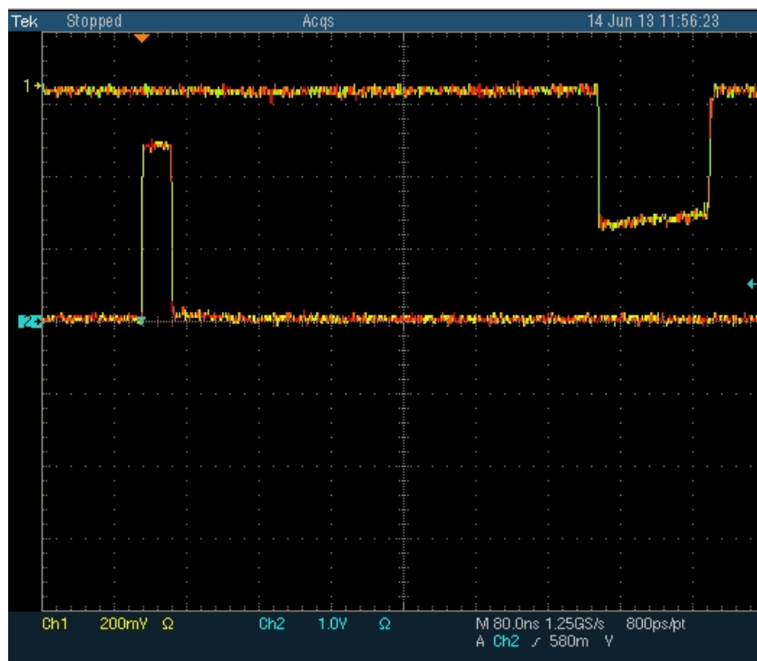
Figura 5.19 – Sinal de disparo gerado pelo Módulo de Detecção de Coincidências (canal 2, curva inferior) e sinal de disparo gerado pelo módulo NIM (canal 1, curva superior).
