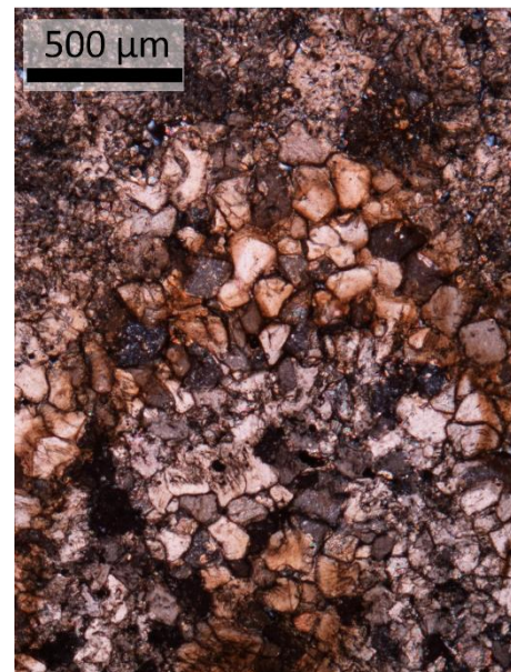
Fotografia 5.38 – Aspeto microscópico de fácies bandada, provavelmente associada a algas e/ou bactérias. Bandas claras com esparite romboédrica pristina e bandas de tonalidade castanha, que podem atravessar os cristais ( amostra OP-1(2)-V ).
