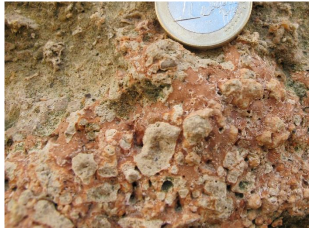
Fotografia 6.16 – Brecha de clastos carbonatados, geralmente até 5 mm, com cimento de cor ocre-avermelhada.
