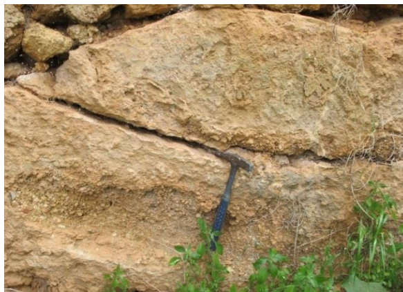
Fotografia 5.62 – Tufo calcário microdetritico com lente de materiais siliciclásticos e intraclastos com crosta de óxidos/hidróxidos de ferro no topo.
