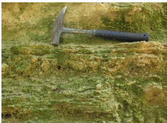
Fotografia 5.57 – Tufo calcário micrítico, com lentes de tufo calcário mais fortemente consolidado em Goncinha.
