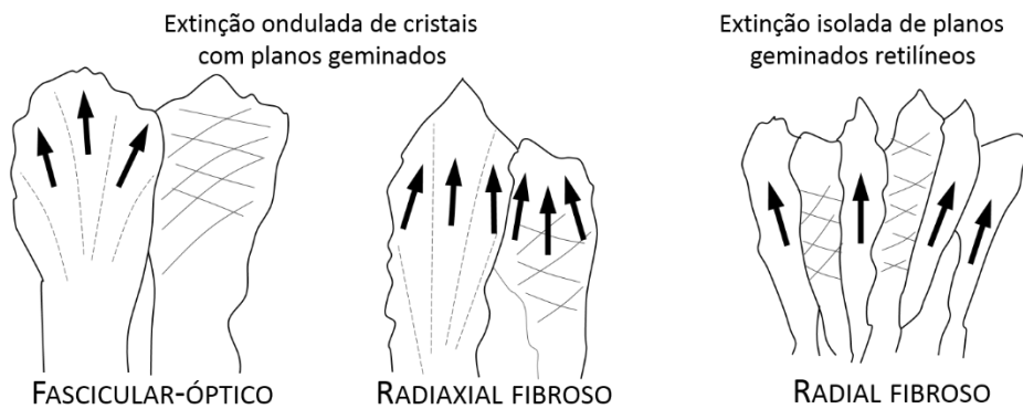
Figura 2.21 – Calcite colunar de textura radiaxial fibrosa, fascicular-ótica e radial fibrosa. As setas demonstram as direções de fast vibration em cada caso, e as linhas tracejadas representam os limites dos subcristais (adaptado de Tucker e Wright (1990) segundo Kendall (1985)).
