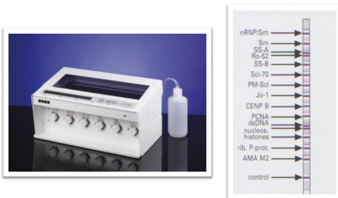
Figura 6 – EUROBlotMASTER da Euroimmun; Imunoblotting – (ANA Profile 3®) – Identificação de anticorpos antinucleares e anti-citoplasmáticos
