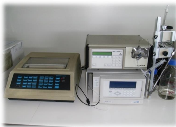
Figura 19 - Sistema de cromatografia líquida de alta eficiência (HPLC) utilizado na determinação do ergosterol.
