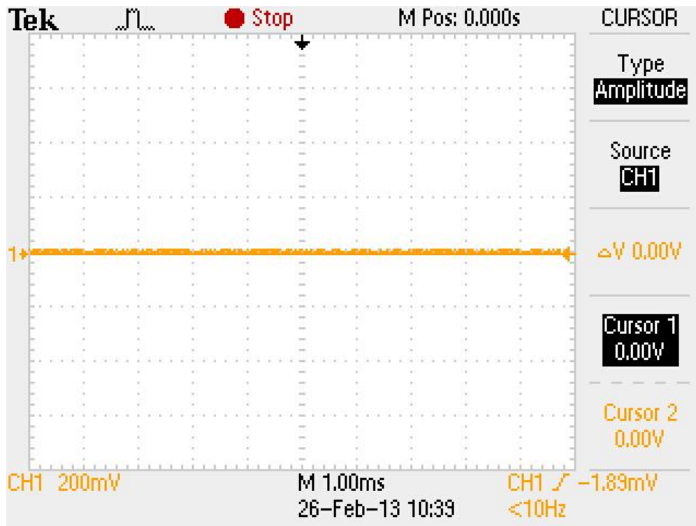
Figura 63 Tensão do pino \overline{CS} no ADS1192, medido com o osciloscópio.
