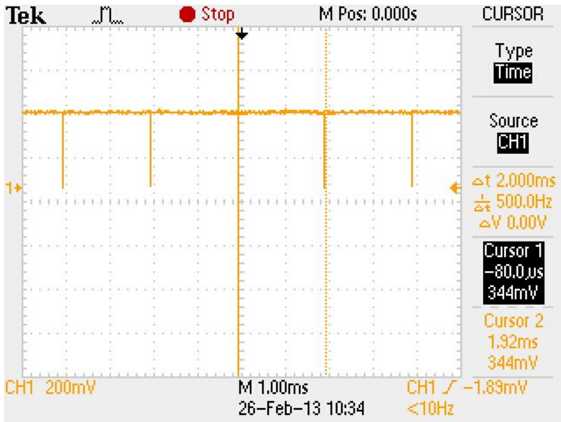
Figura 72 Sinal do pino \overline{DRDY} , calculado com o auxílio do osciloscópio.
