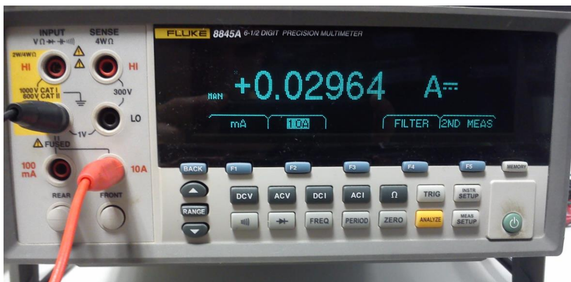
Figura 97 Consumo elétrico médio do sistema desenvolvido (PCB & ATmega 128).
