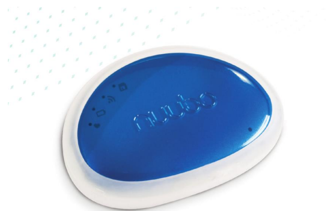
Figura 116 Dipositivo desenvolvido igualmente pela empresa Nuubo e que funciona paralelamente com os elétrodos wereable da figura 115. Permite armazenar os dados através de um cartão SD e/ou o seu envio remoto em tempo real. (80)
