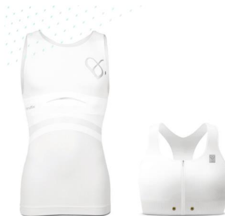
Figura 115 Elétrodos wearable textéis, tecnologia da empresa Nuubo , Madrid, Espanha. O seu funcionamento está acoplado ao dispositivo da figura 116, dispositivo sem fios que regista a informação captada pelos elétrodos e possibilita a sua transmissão remota, em tempo real. (80)
