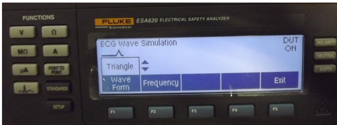
Figura 81 Sinal gerado pelo ESA 620 com formato triângular.
