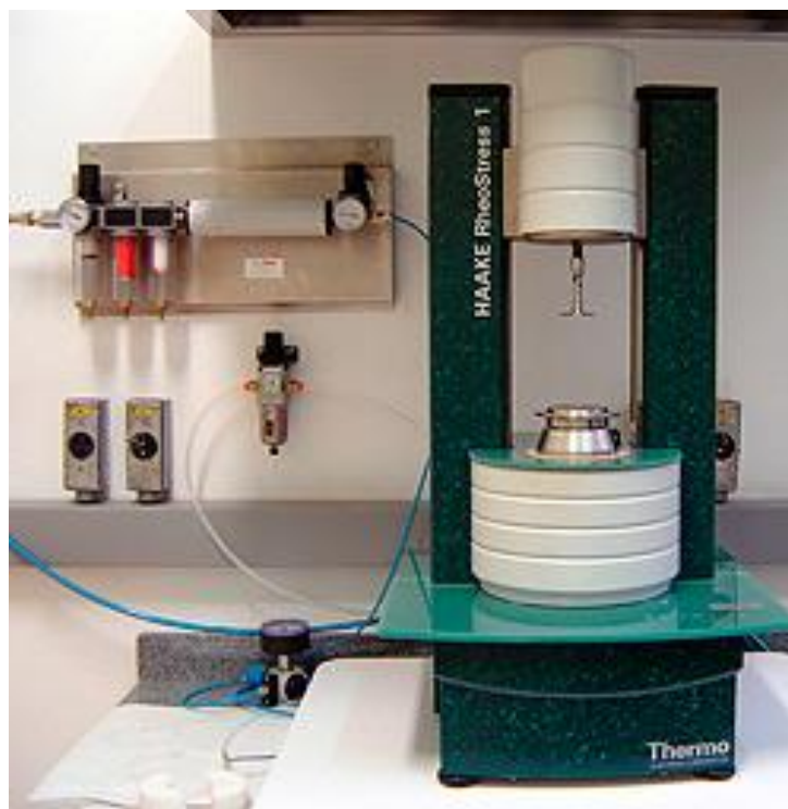
Figura 11: Reómetro equipado com o sistema prato-prato (Sabadini, n.d.).
