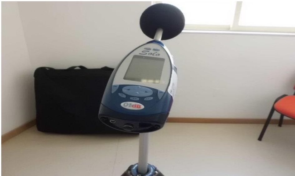
Figura 14 – Sonómetro utilizado nas medições dos níveis de pressão sonora
