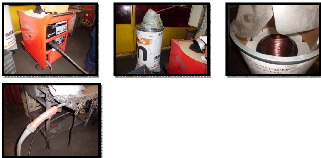
Figura 28 - Processo de soldadura: equipamentos utilizados.
