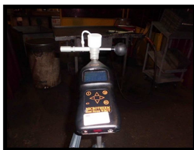
Figura 33 - Localização dos pontos de medição, para a avaliação do ambiente térmico.
