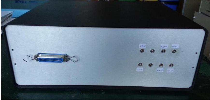
Figura 4-11 - Painel frontal do sistema de aquisição.
