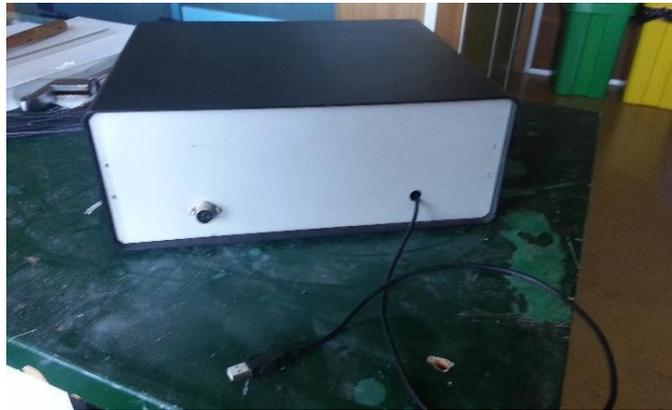
Figura 4-13 - Painel traseiro do sistema de aquisição.
