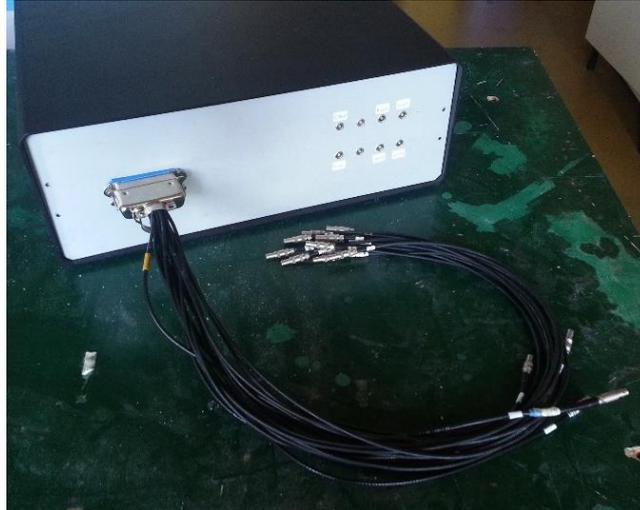
Figura 4-12 - Cabo de ligação do detector ao sistema de aquisição (Ficha Centronix - 17 fichas LEMO fêmeas).
