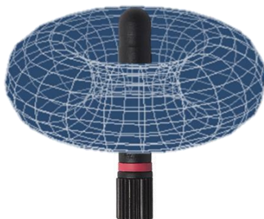
Figura 16 – Imagem exemplificativa do padrão de emissão teórico de uma whip antena
