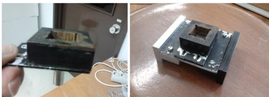
Figura 32-Suportes desenvolvidos para os estudos fotoquímicos em fluidos supercríticos (do lado esquerdo suporte utilizado na fotólise por relâmpago do lado direito suporte utilizado no UV/Visível)
