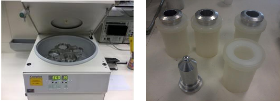
Figura 2.3: Centrífugadora Centurion K40 (lado direito). Cuvetes usadas na centrífugadora (lado esquerdo)
