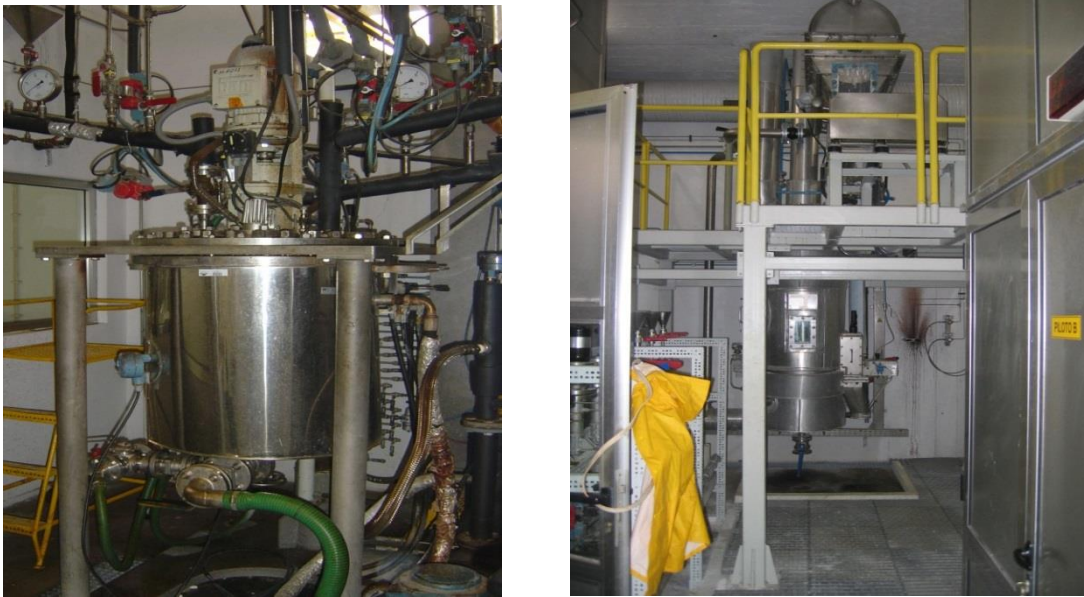
Figura 1.18: Reactor da linha A de polimerização. (lado esquerdo) Secagem da linha A de polimerização. (lado direito)
