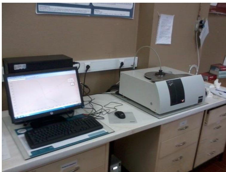
Figura 2.8: TG 209 F3 Tarsus ® , da NETZSCH.
