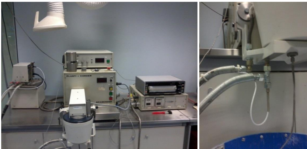
Figura 2.1 Brabender Plasticorder PLE 331 equipado com misturadora planetária P600 do lado esquerdo. Lado direito sensor de temperatura à entrada do óleo na misturadora.
