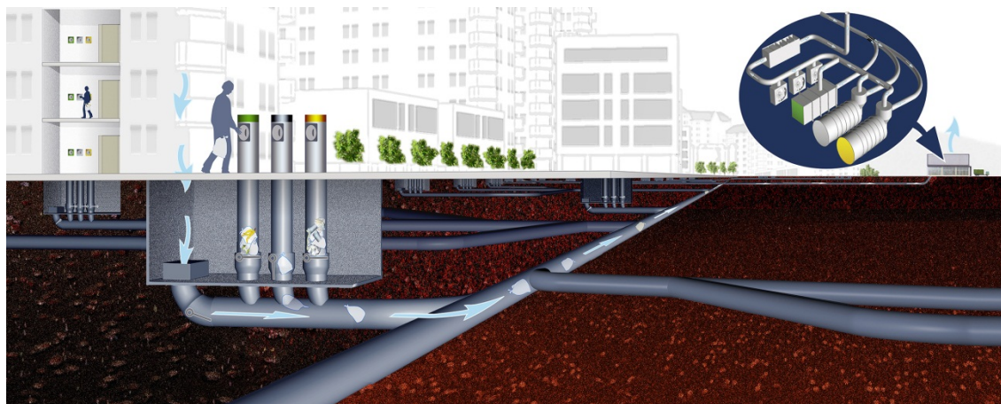
Fig. 103 - Sistema estacionário, onde os resíduos são encaminhados para centrais de recolha.
