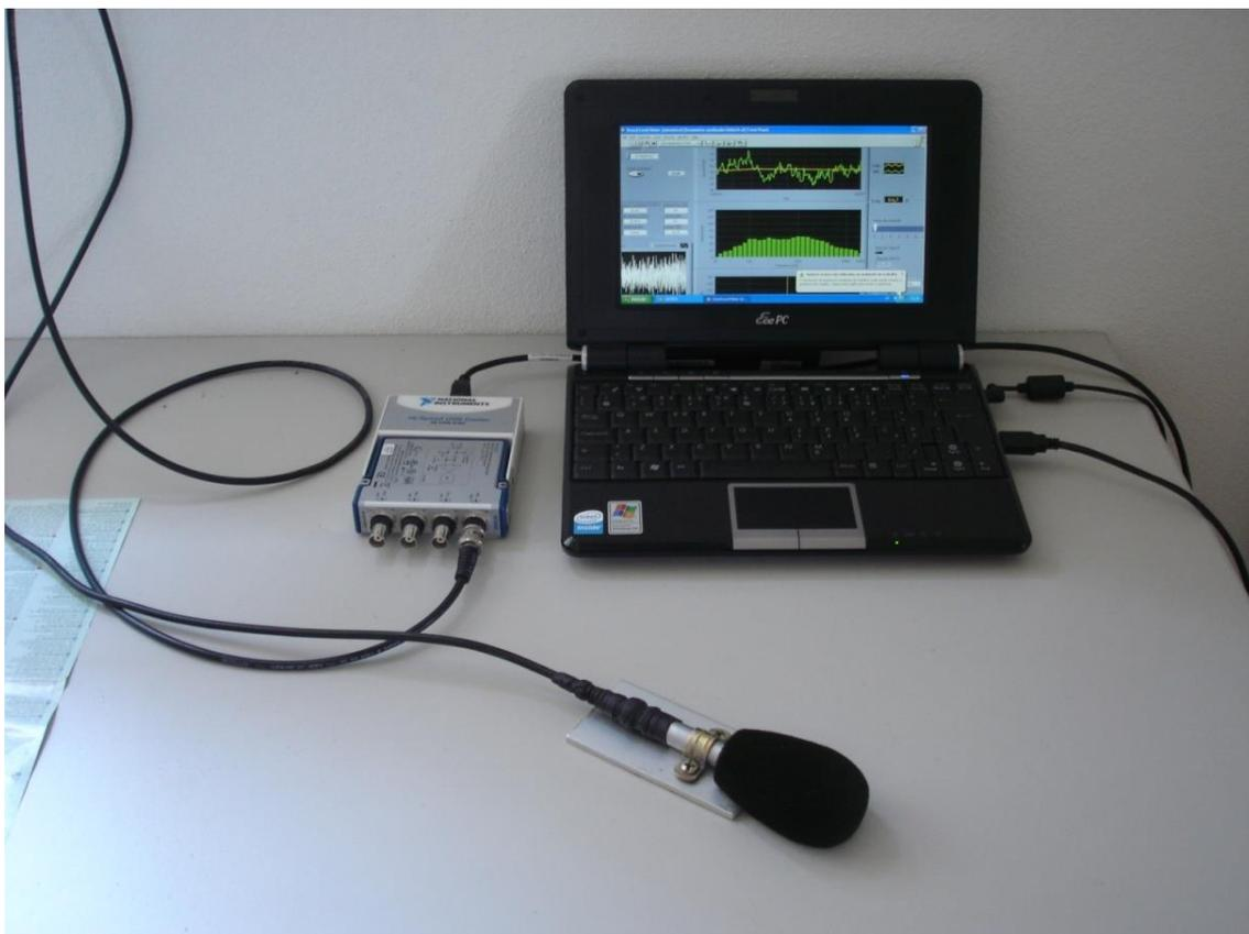
Fig. 5.1 – Sistema de monitorização contínua (instalação experimental)
