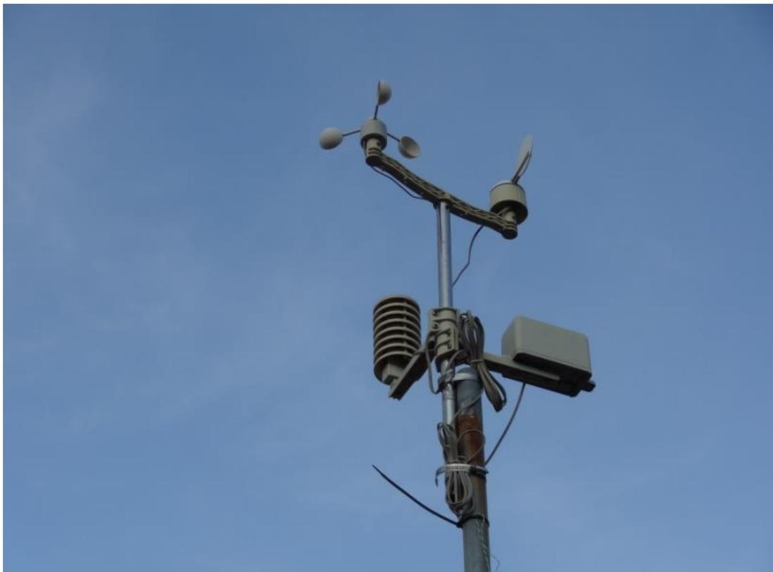
Fig. 5.11 – Estação meteorológica utilizada para a aquisição dos parâmetros meteorológicos
