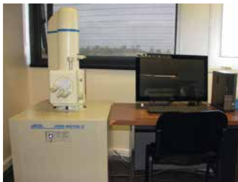
Figura 32: Microscópio eletrônico de varrimento JSM-6010LV.
