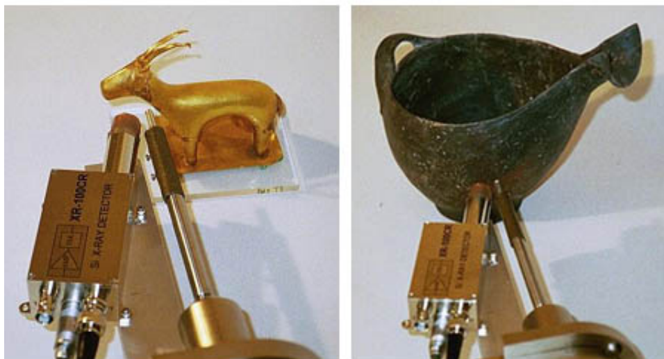
Figura 3.5: Análise por espectrometria de fluorescência de raios-X sobre uma pequena estátua ( Ibex ) (esquerda) e um vaso antigo de origem grega (direita).
