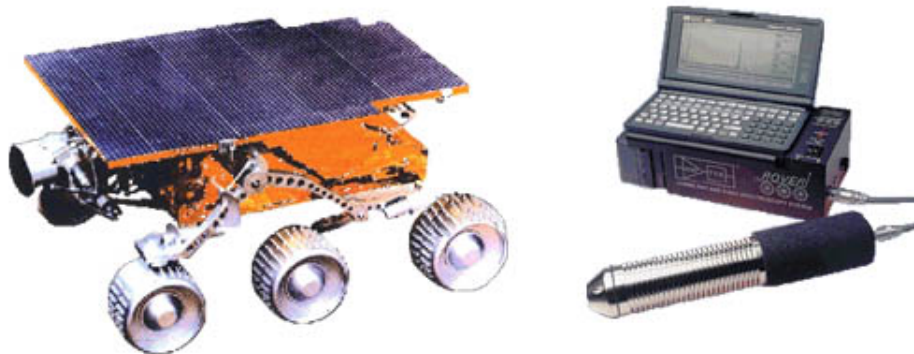
Figura 3.4: A pequena sonda Mars Sojourner (à esquerda) equipada com um detector do tipo CZT para análise espectrométrica (à direita) fornecido pela Amptek.
