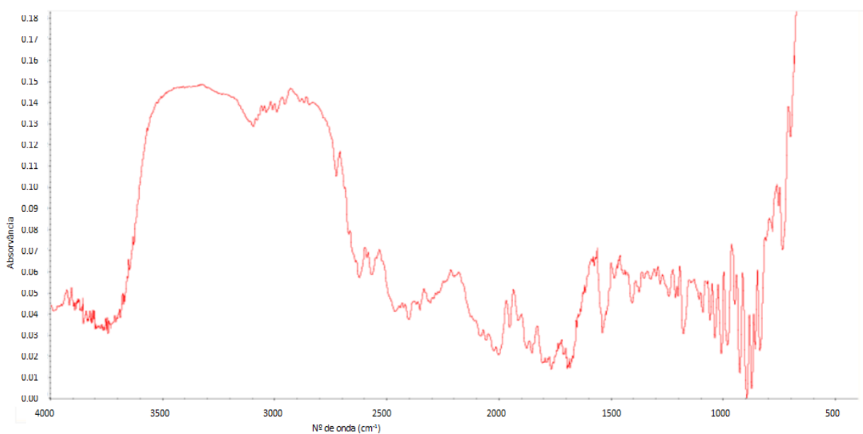
Figura 65 - Espectro de infravermelho obtido para uma partícula de contaminante manipulado pelo voluntário 14.
