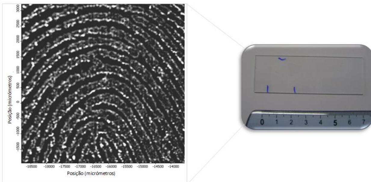
Figura 28 - Imagem química de um vestígio digital (à esquerda) numa lâmina de vidro (à direita). A imagem química, com tamanho 4,5 mm x 4,5 mm, foi registada no modo de transmissão, com uma resolução espectral de 32\text{ cm}^{-1} e 4 scans a partir da 2ª derivada a um número de onda de 2850\text{ cm}^{-1} .
