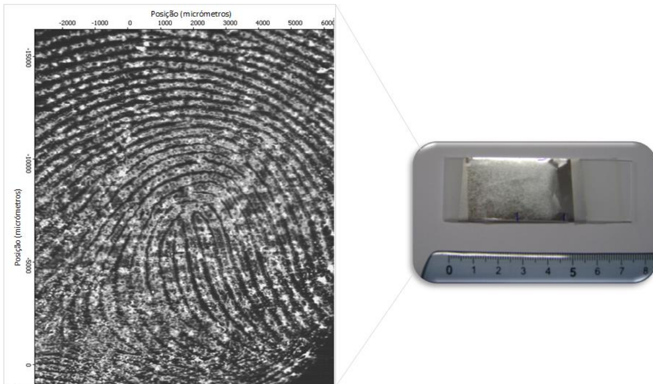
Figura 30 - Imagem química de um vestígio digital (à esquerda) numa folha de papel de alumínio (à direita). A imagem química, com tamanho 8,5 mm x 2 cm, foi registada no modo de reflexão com uma resolução espectral de 32\text{ cm}^{-1} e 4 scans a partir da 2ª derivada a um número de onda de 2929\text{ cm}^{-1} .
