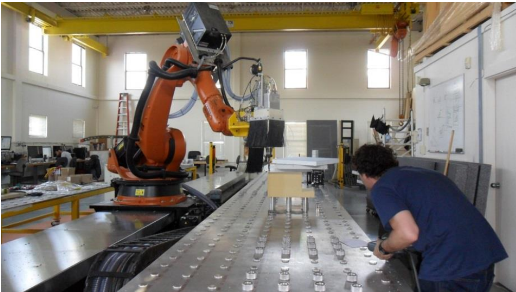
Figura 27. Ensaio de maquinação de capitel jônico com braço robótico Kuka 350.
