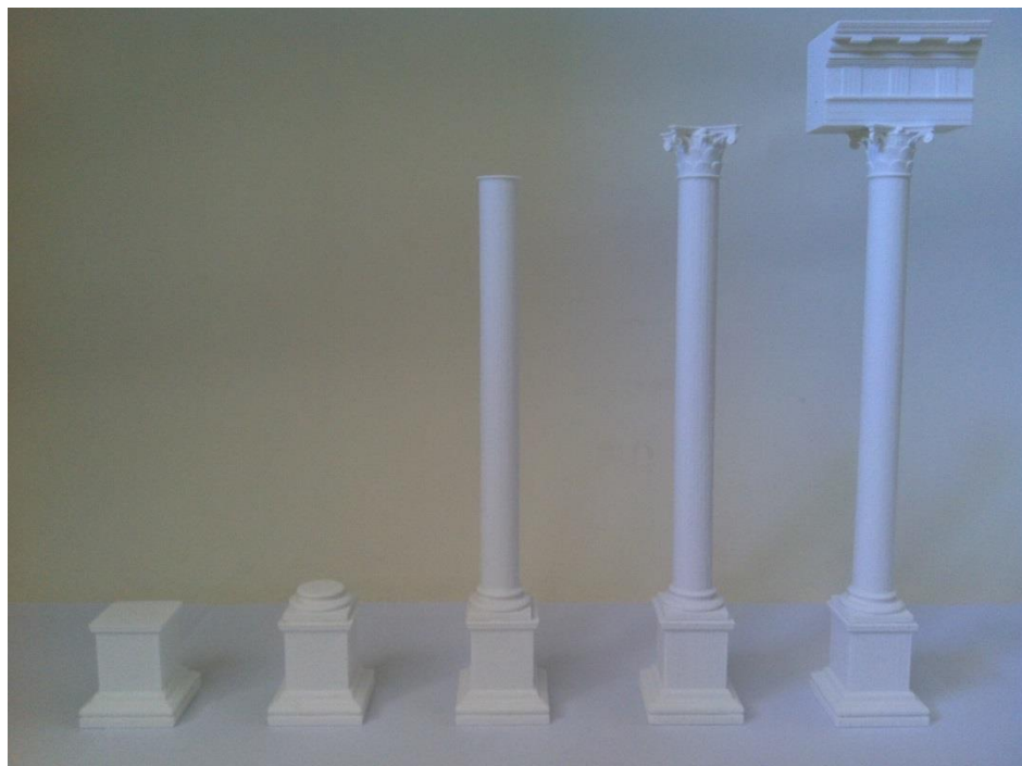
Figura 46. Protótipos representando uma derivação com a combinação de um pedestal, uma base dórica, um fuste liso, um capitel coríntio e um entablamento dórico .
