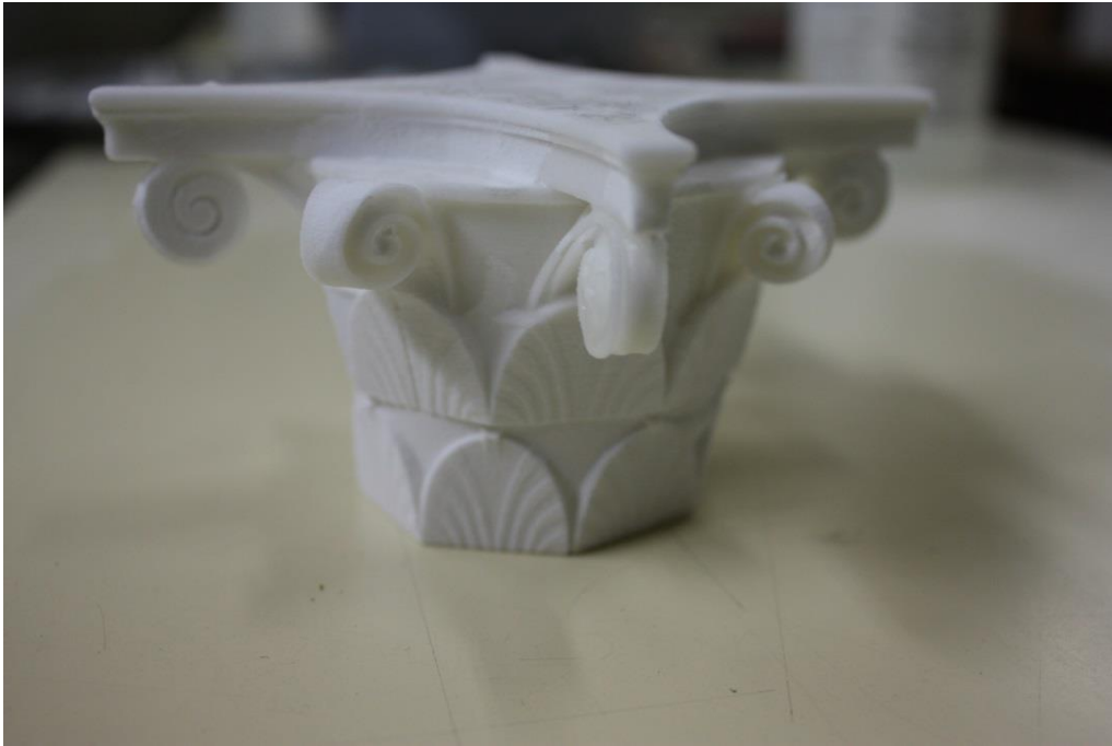
Figura 43. Protótipo de capitel coríntio fabricado com impressora 3d Zcorp
