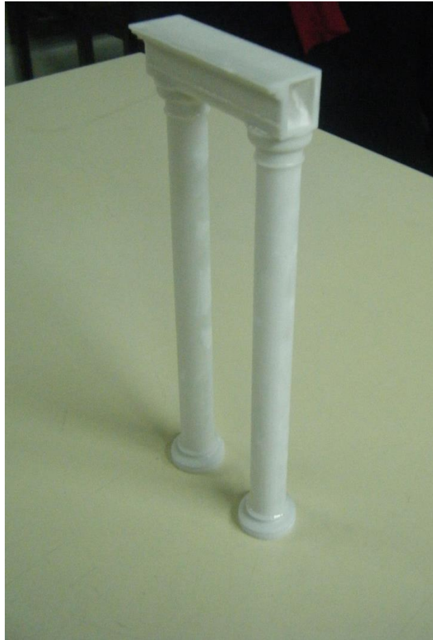
Figura 38. Protótipo de pórtico com entablamento fabricados com impressora 3d Zcorp.
