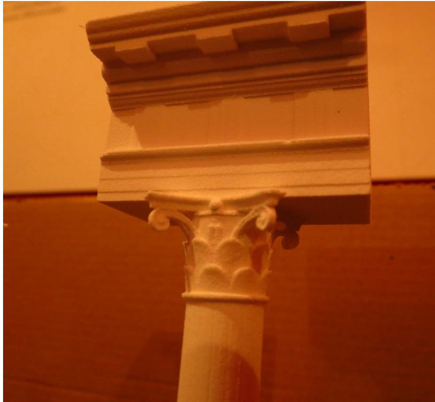
Figura 45. Protótipo de entablamento dórico com triglifos, capitel coríntio e fuste fabricado com impressora 3d Zcorp
