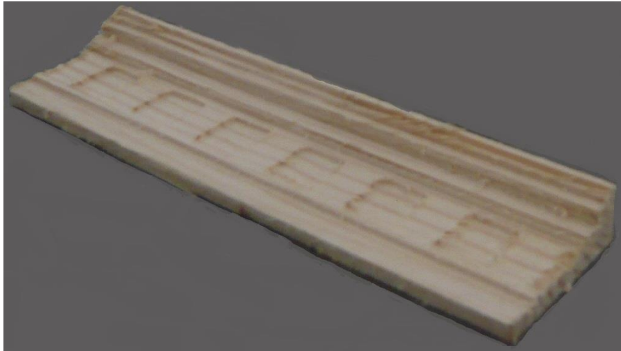
Figura 22. Protótipo de entablamento em madeira fabricado por fresadora de 3 eixos Tecmacal.
