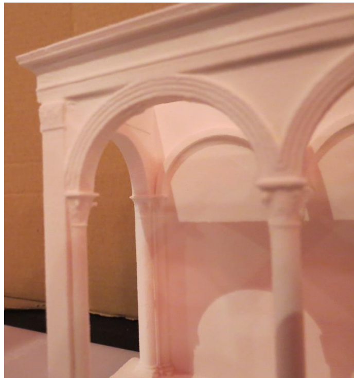
Figura 52. Pormenor do Protótipo da Loggia Rucellai fabricada com impressora 3d Zcorp.
