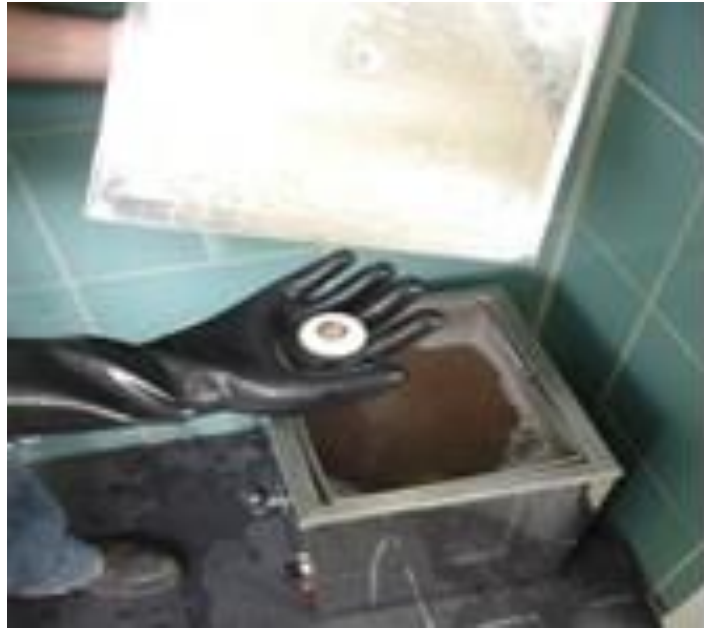
Figura 57. Tratamento do protótipo na tina de solvência do PPSF.
