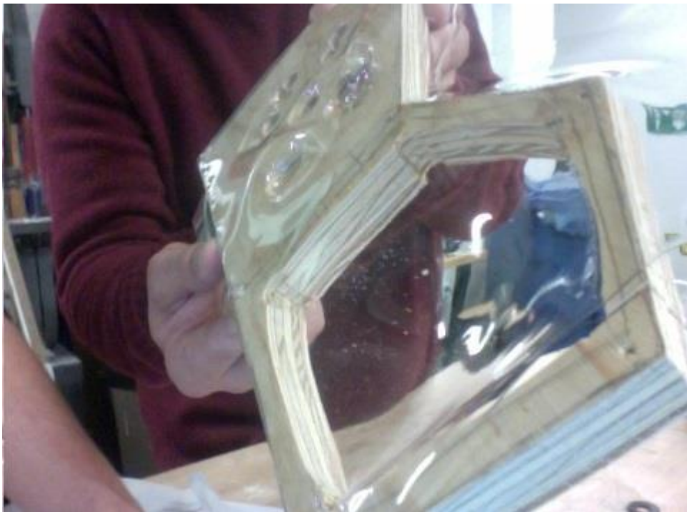
Figura 61. Protótipo fabricado por deformação térmica. Molde em contra placado para duas experiências.
