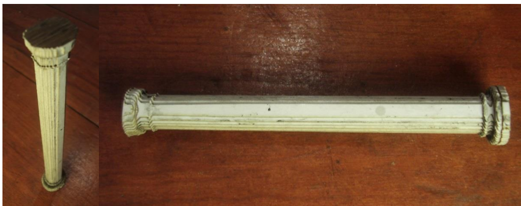
Figura 16. Protótipo da coluna com capitel e base dórica fabricado com cortadora a laser Universal
