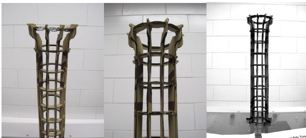
Figura 17. Protótipo da coluna com capitel e base dórica fabricado com cortadora a laser Universal
