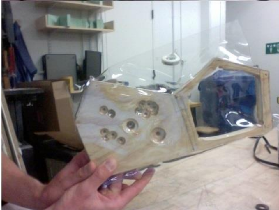
Figura 62. Protótipo fabricado por deformação térmica. Molde em contra placado para duas experiências. Com relevos de pequena dimensão e dimensão maior.
