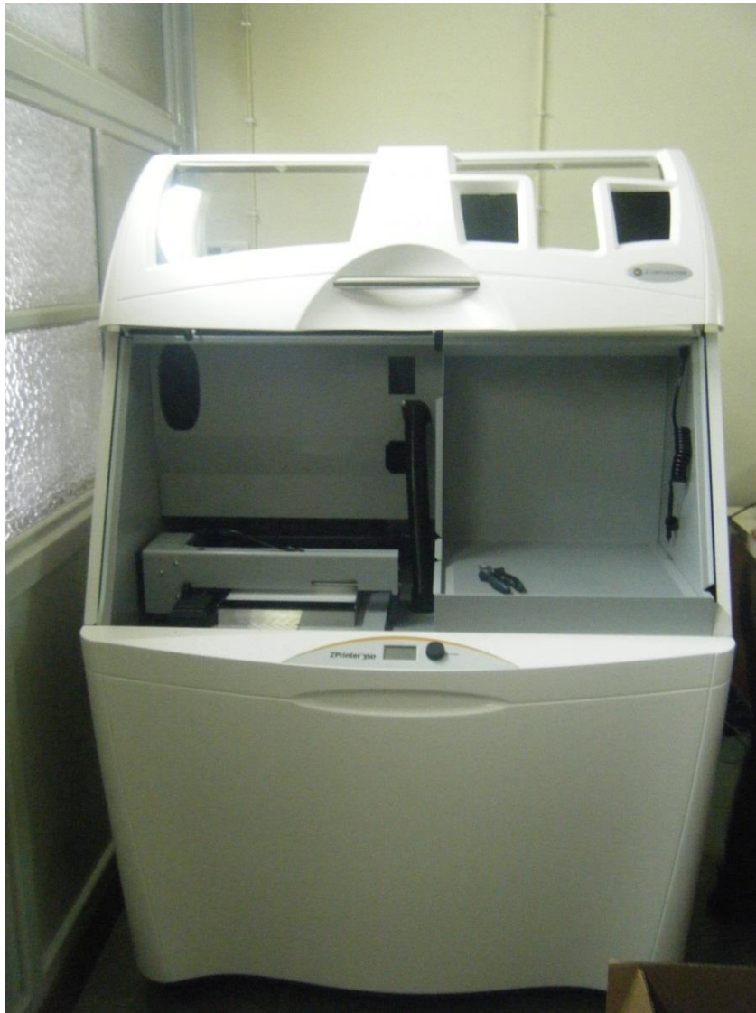
Figura 35. Impressora 3d printer ZCorp. À esquerda modulo de impressão. À direita câmara de tratamento dos modelos fabricados.
