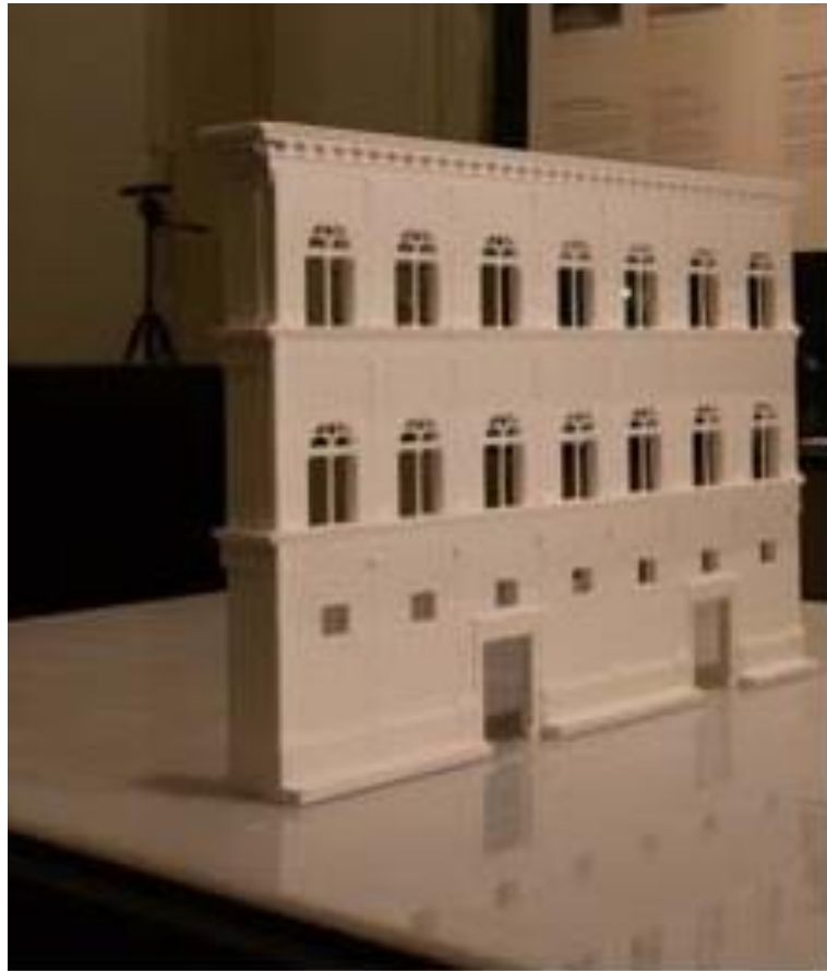
Figura 47. Protótipo da fachada do palácio Rucellai fabricada com impressora 3d Zcorp
