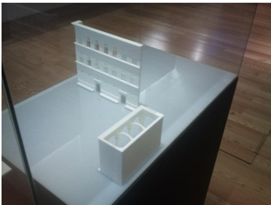
Figura 49. Vista conjunta da fachada do palácio e da Loggia Rucellai fabricados com impressora 3d Zcorp.
