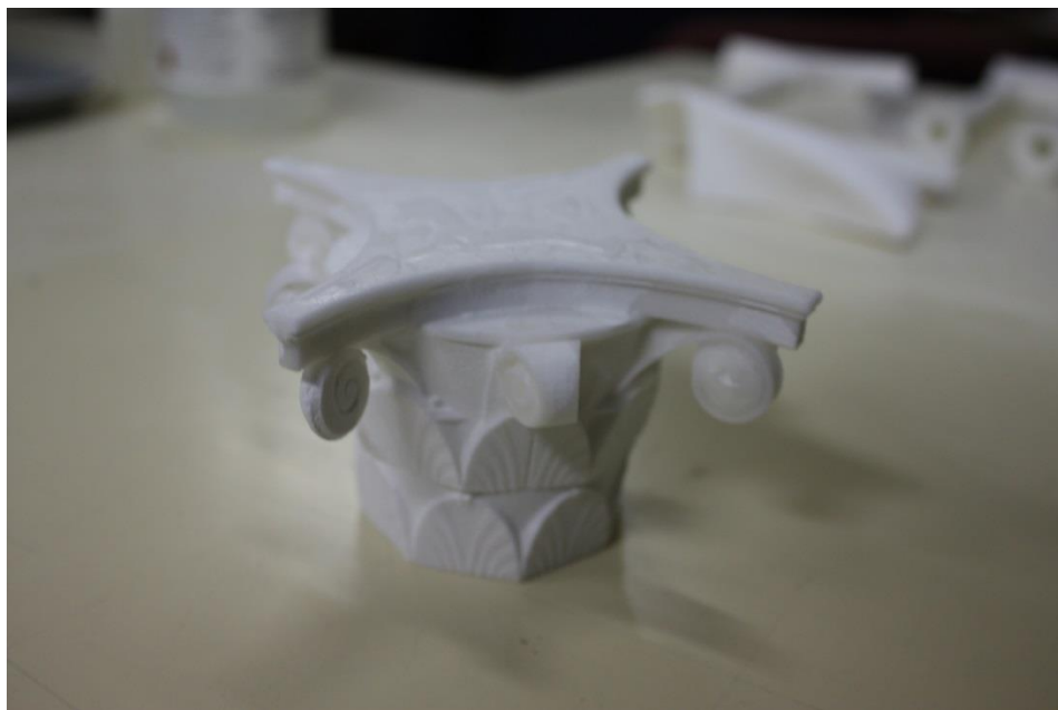
Figura 42. Protótipo de capitel coríntio fabricado com impressora 3d Zcorp.
