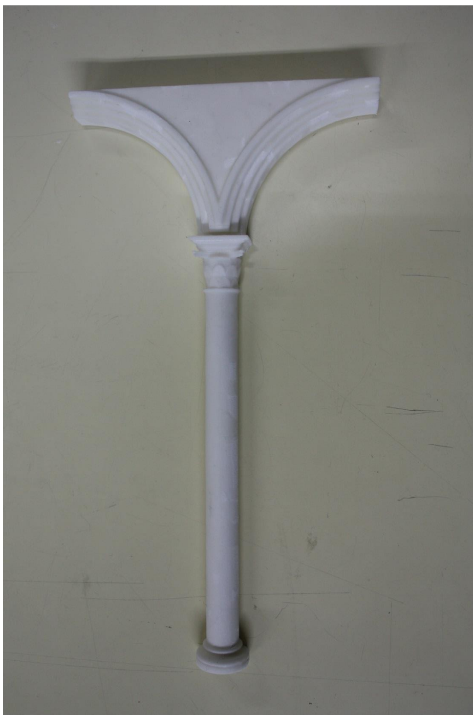
Figura 40. protótipo de coluna com base dórica, fuste liso, capitel coríntio, latastrum e meios arcos fabricado com impressora 3d Zcorp.
