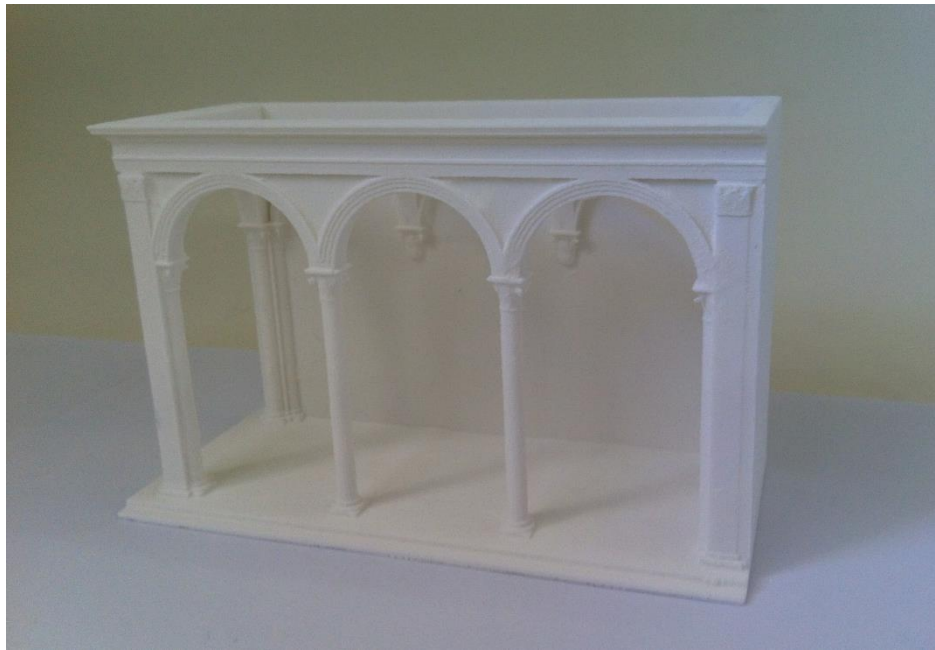
Figura 51. Protótipo da fachada da Loggia Rucellai (não analisada na tese) fabricada com impressora 3d Zcorp
