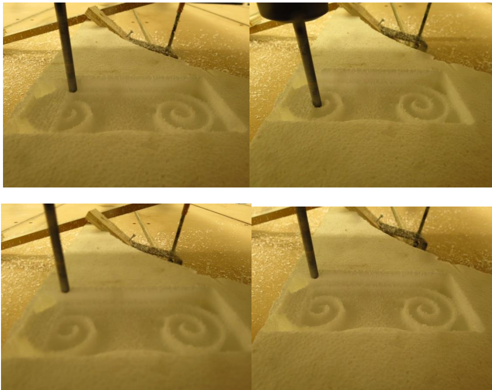
Figura 25. Sequencia de frezagem do protótipo do capitel jónico.
