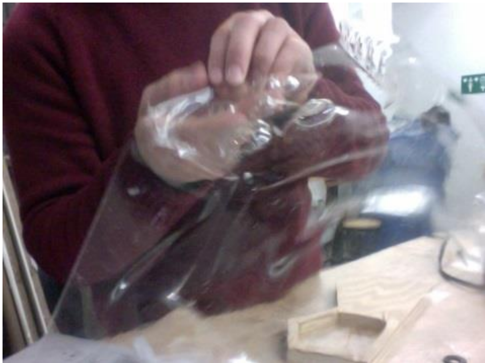
Figura 63. Destacamento do molde do protótipo fabricado por deformação térmica.
