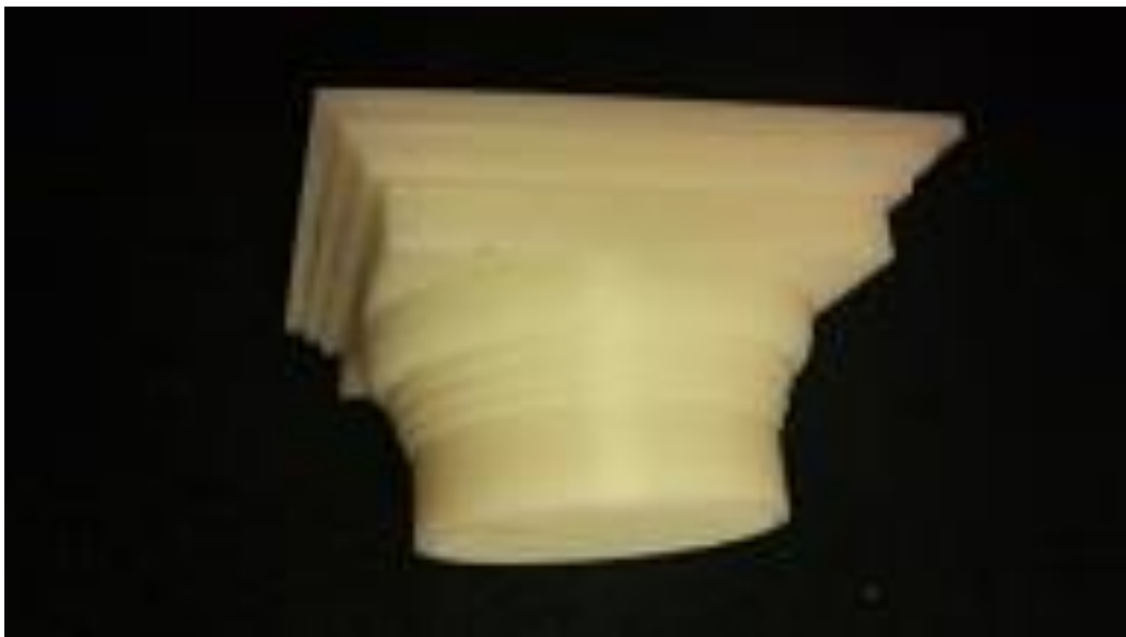
Figura 58. Protótipo de capitel dórico em plástico ABS fabricado com impressora 3d Stratasys Dimension Elite.
