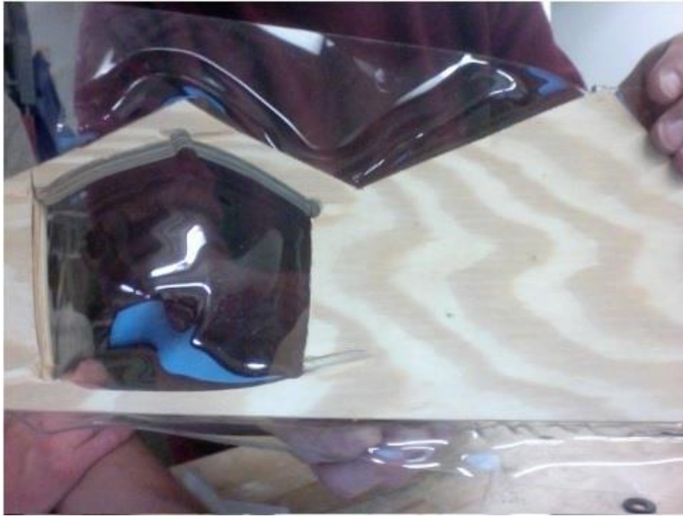
Figura 60. Protótipo fabricado por deformação térmica através de Eat Gun.
