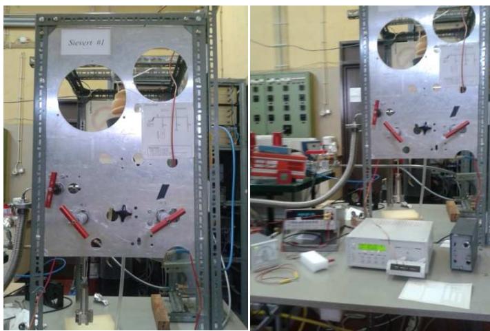
Figura 4.1 - Sistema volumétrico para adsorção de CO 2 onde podemos ver, na fotografia do lado esquerdo, as válvulas de operação do sistema e câmara onde fica introduzida a amostra e, na fotografia do lado direito, os aparelhos que auxiliam as medidas.
