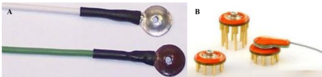
Figura 1.7 – Exemplo de eléctrodo não invasivos: (A) eléctrodo húmido de Ag e AgCl da Universidade de Grent; (B) eléctrodo seco de g.@SAHARA.
