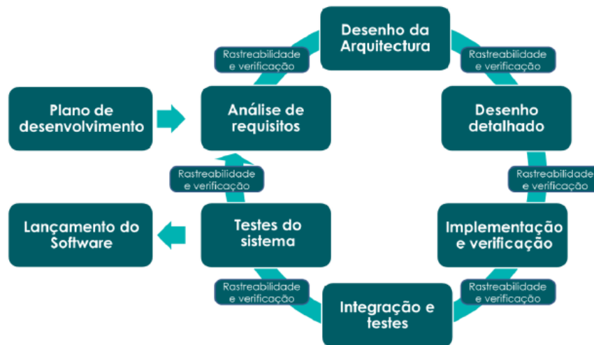
Figura 8 - Representação do ciclo de vida do Software em conformidade com o modelo AGILE e com a norma IEC - 62304. [8]
