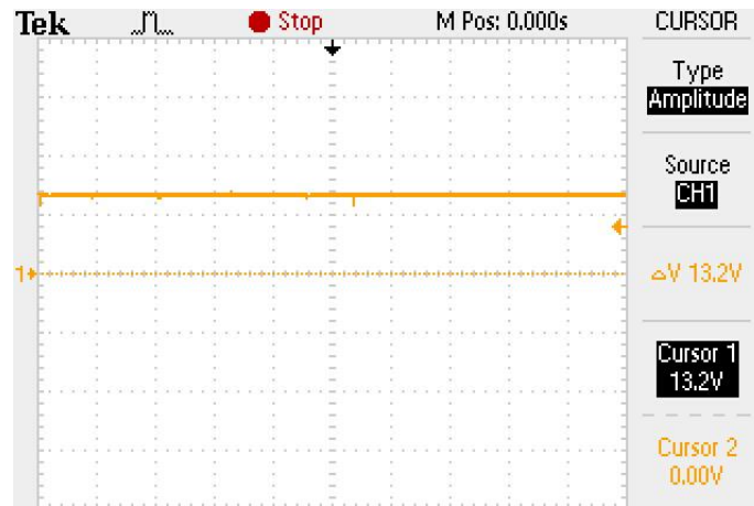
Figura 37 Tensão DC gerada pelo duplicador de tensão
