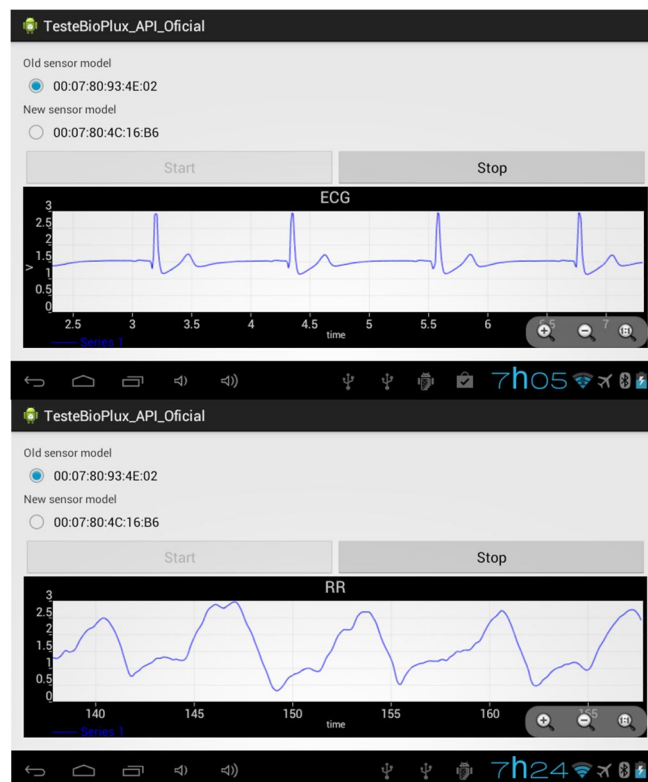
Figura 61 - Imagens da aplicação bioPLUX com apresentação gráfica de valores de ECG (em cima) e respiração (em baixo).
