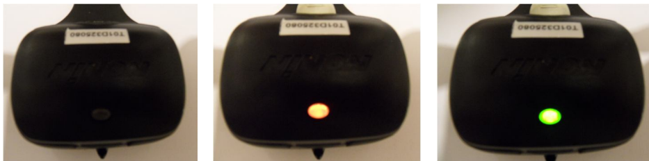
Figura 31 - Os três estados do LED informativo: LED apagado (à esquerda), LED laranja intermitente (ao centro) e LED verde intermitente (à direita).
