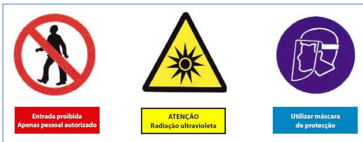
Figura 16: Sinalização típica utilizada no ambiente de trabalho para avisar da existência de perigos e recomendar a utilização de equipamento de protecção individual. Toda a sinalização de segurança deve cumprir os requisitos da Directiva de Sinalização de Segurança (92/58/CEE) adaptado do Guia de boas práticas não vinculativo da Directiva 2006/25/CE [2].
