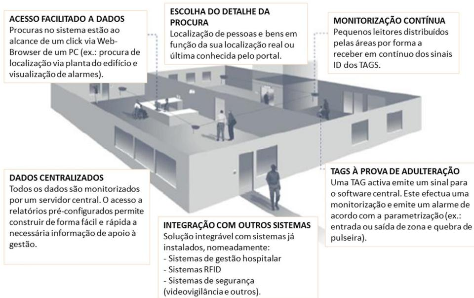
Figura 28 – Esquema ilustrativo da solução TraceMe® (Fonte: [100])
