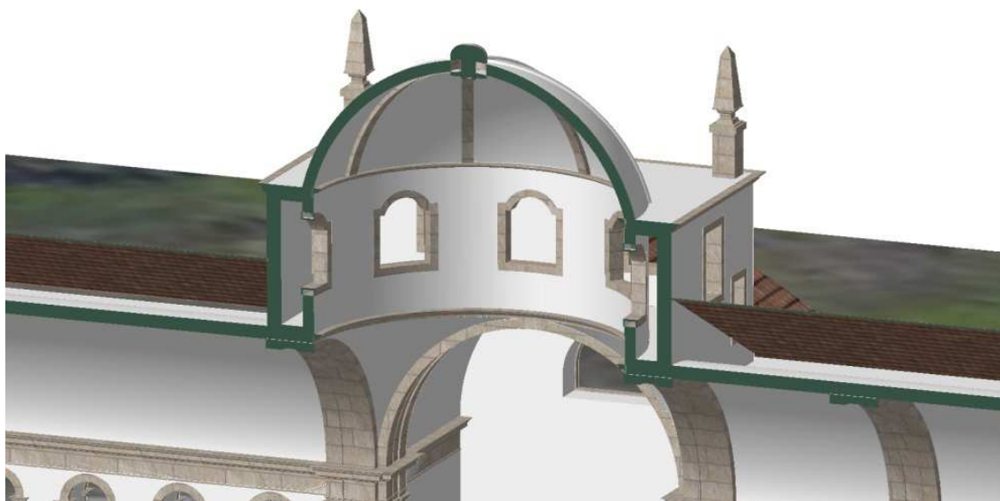
Imagem 22 – Corte do interior da Igreja do Mosteiro de Seiça – pormenor da cúpula em varandim, com cobertura abobadada
