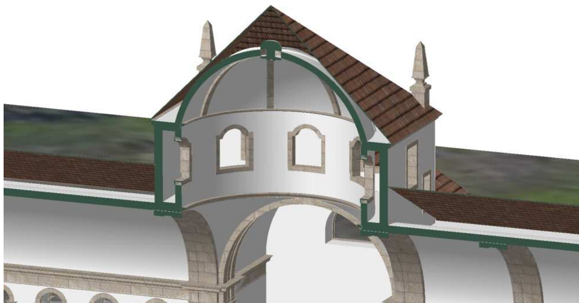
Imagem 21 – Corte do interior da Igreja do Mosteiro de Seiça – pormenor da cúpula em tambor, com cobertura de telhado de quatro águas
