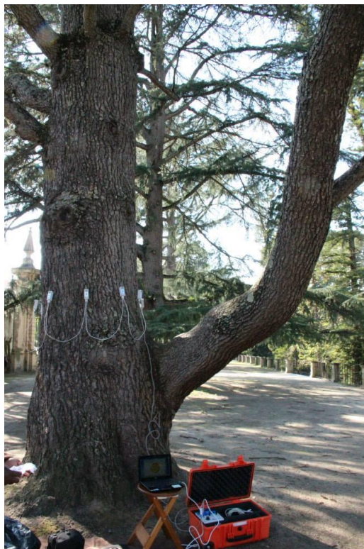
Figura 2.17. Exemplo de instalação dos sensores do ARBOTOM.
