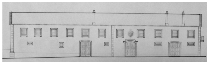
Fig. 119 - Alçado de levantamento do Centro de Espariz.
