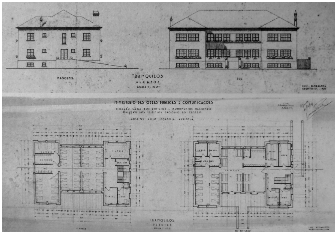
Fig. 90 - Alçados e plantas dos Pavilhões 3, 8 e 12 (Tranquilos) do Hospital Sobral Cid.
