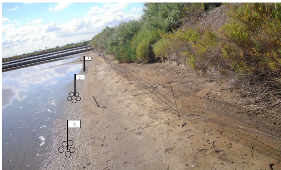
Figura 2 - Esquema da amostragem realizada em cada salina. Em cada salina foram recolhidas, com um core de 10,2 cm de diâmetro, 5 amostras (círculos) de três locais de amostragem (1 a 3).
