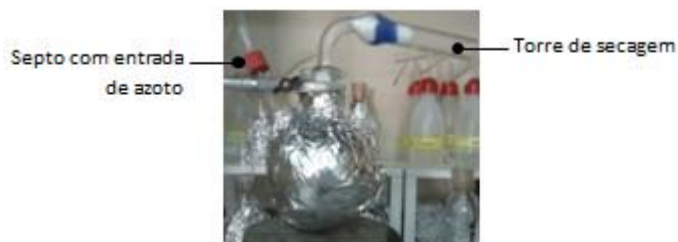
Figura 3.6. Montagem experimental adoptada na síntese da H 2 TCP pelo método de Lindsey.
