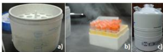
Figura 3.19. Criopreservação de células. (a) Após a preparação da suspensão celular com a densidade desejada, colocam-se os crio-tubos num recipiente de congelação com isopropanol. Após 5 h a -80\text{ }^{\circ}\text{C} , transferem-se os crio-tubos para (b) uma caixa de preservação que é posteriormente introduzida (c) num contentor de azoto líquido a -196\text{ }^{\circ}\text{C} .
