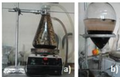
Figura 3.2. Montagens experimentais utilizadas para efectuar as lavagens (a) em contínuo e (b) com uma ampola de decantação.
