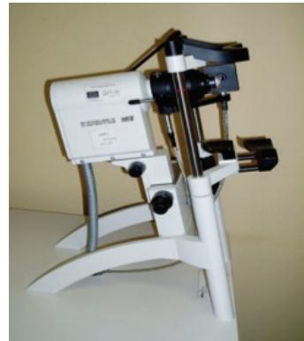
Figura 2.4 - Microscópio confocal da córnea de varrimento laser: (a) Arranjo óptico. Adaptado de (Guthoff, 2006); (b): Heidelberg Retina Tomograph HRT II associado ao Rostock Cornea Module. CRIO - CHUC.
