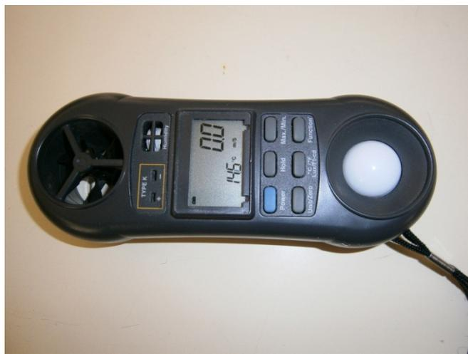
Figura 2.7 –Medidor multifunções com anemómetro integrado.
