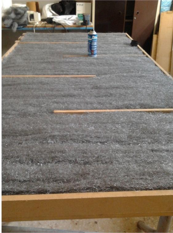
Figura 3.5 – Coletor com matriz porosa antes da fase de pintura.
