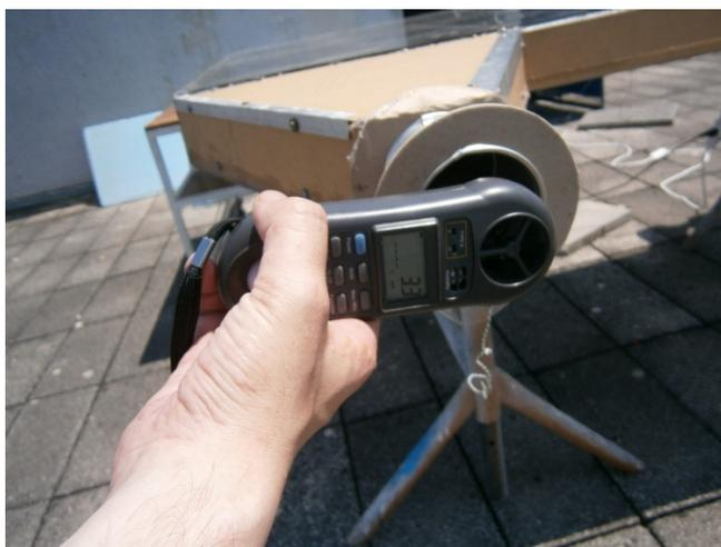
Figura 3.18 – Medição da velocidade do ar durante um ensaio.
