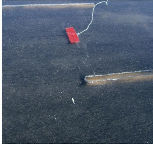
Figura 3.16 – Detalhe de um termopar colocado na cobertura de vidro.
