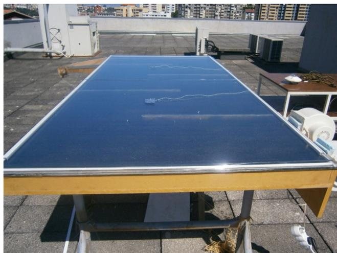
Figura 3.10 – Coletor solar com vidro duplo e caixa de ar de 1,5cm.
