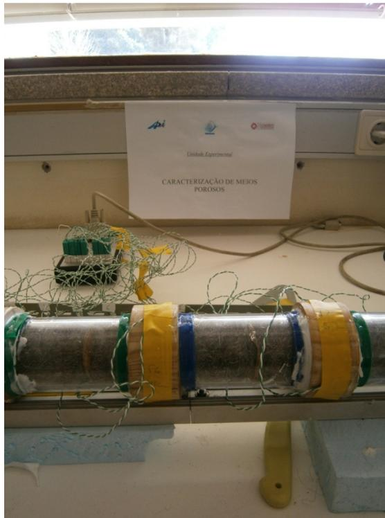
Figura 2.5 – Detalhe da instalação com termopares conectados a uma interface PICO TC-08.
