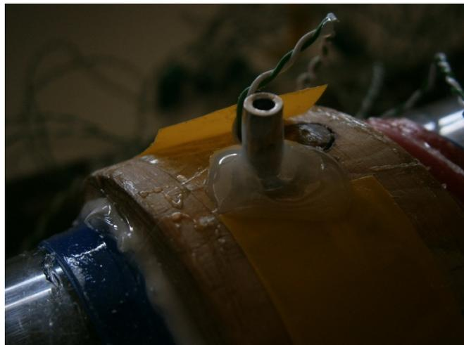
Figura 2.6 – Detalhe de uma tomada de pressão.
