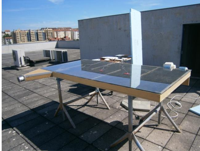
Figura 3.11 – Coletor solar instalado no terraço do LAI-ADAI.
