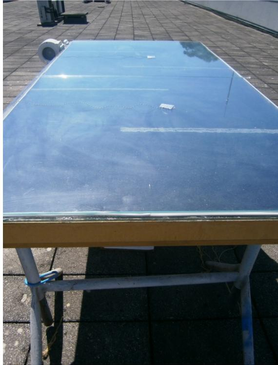
Figura 3.9 – Coletor solar com vidro duplo e caixa de ar de 1,5mm.
