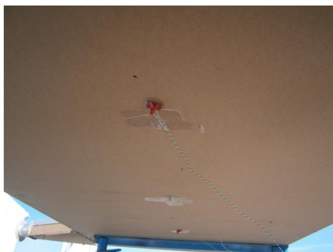
Figura 3.14 – Pormenor da parte inferior do coletor com alguns dos termopares conectados.
